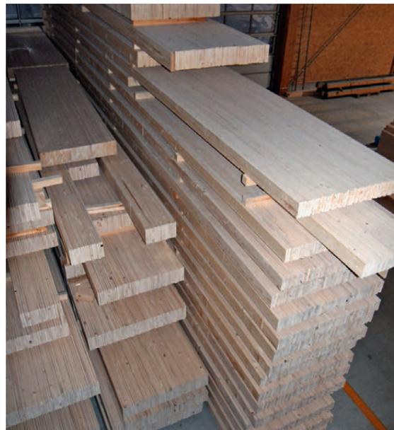
Brettschichtholz für Deckenelemente liegt im Produktionszentrum Root für die Weiterverarbeitung bereit.
